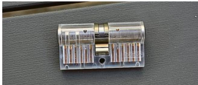
Mit feinen Abtastwerkzeugen öffnen Nils Trexler und Sirius Schmidt (links) die Schlösser. Die Werkzeuge werden in Sets verkauft und nach Schlossgröße angepasst eingesetzt. Gut zu erkennen sind in dem durchsichtigen Schloss die Schließstifte.
